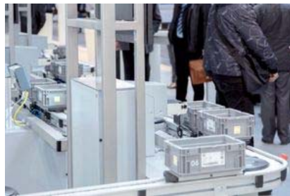
Harting a équipé des casiers de puces RFID qui communiquent avec les machines.
