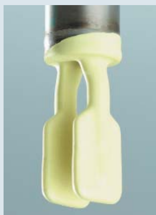
Colmatage de la fourche
