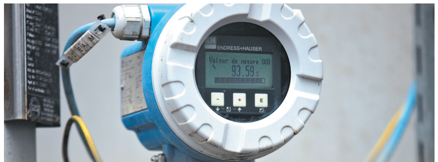
Radar filoguidé équipant une cuve de stockage
